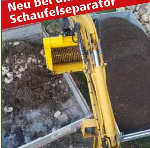
Der Schaufelseparator sibt, trennt, mischt, belüftet und zerkleinert alles vor Ort. Deshalb bleibt praktisch der ganze Humus da und es fällt weniger Material zur Entsorgung an.
