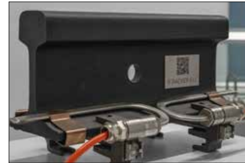
Weichenheizung an der Seitenschiene (Bahnverkehr).
