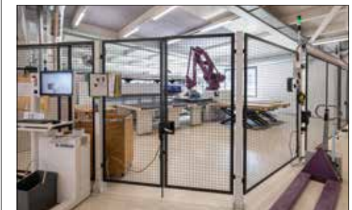
Vollautomatischer Zuschnitt der Einzelteile durch den Roboter.
