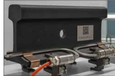
Weichenheizung an der Seitenschiene (Bahnverkehr).
