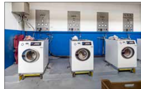
Bevor der Deckel endgültig auf die Waschmaschine kommt, durchlaufen die Geräte einen intensiven Test-Waschgang (links).
